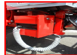
Figure 7 : branchement de la télécommande filaire.
