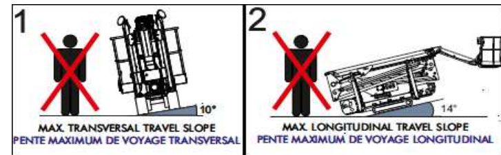
Figure 15 : inclinaisons maximales admises pour la translation.
