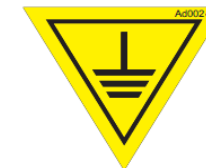
Figure 67 : mise à la terre.
