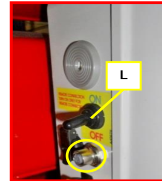
Figure 87 : boîtier de démarrage sur châssis.
