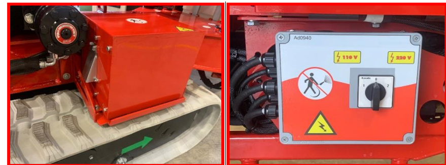
Figure 7a: alternateur et sélecteur (* en option).
