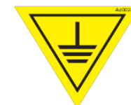
Figure 75 : mise à la terre.
