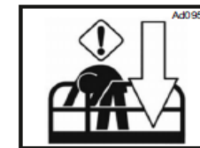
Figure 64 : avertissement pour un éventuel évanouissement de l'opérateur dans la nacelle.
