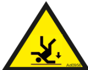
Figure 79 : risque de chute.
