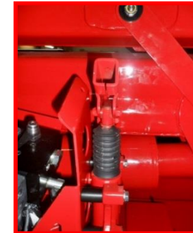
Figure 20 : point d'intégration de la pompe manuelle.
