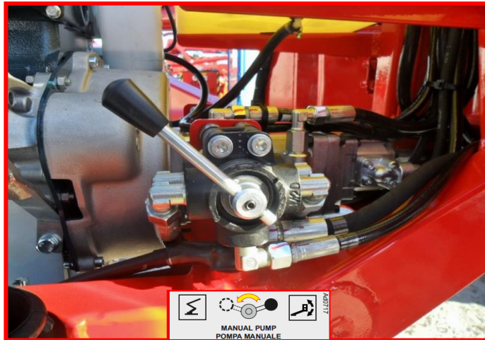
Figure 61 : robinet de la pompe manuelle.
