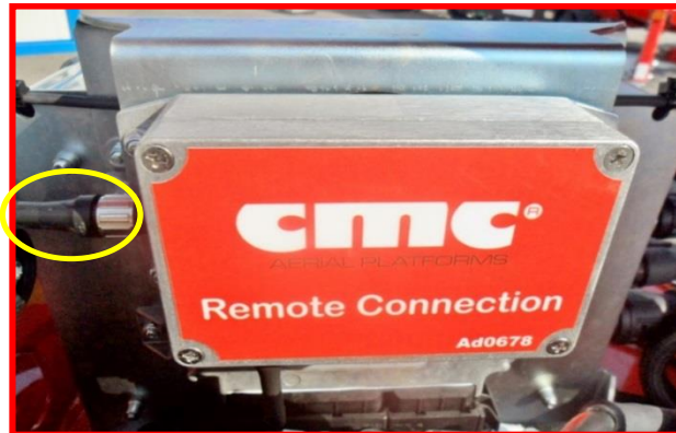
Figure 118 : Boîtier de connexion à distance.
