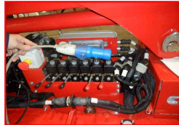
Figure 8 : branchement à la prise 120/230 V.
