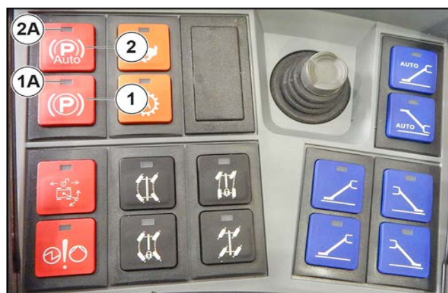
Figure 130: Utilisation du frein de stationnement
