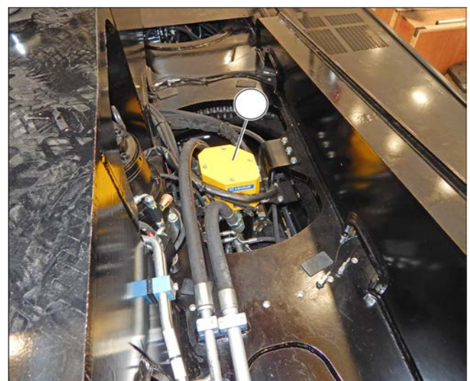
Figure 224: Vérification et nettoyage des bagues émettrices du collecteur électrique rotatif
