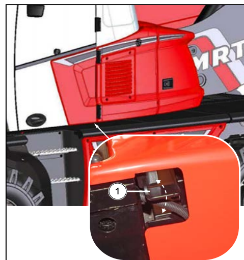
Figure 61: Levier d'ouverture de la vitre de la porte depuis l'extérieur de la cabine
