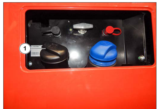
Figure 121: Remplissage du réservoir de carburant
