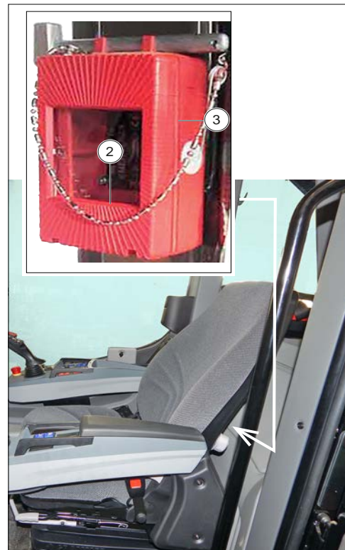
Figure 105: Coffret de sécurité
